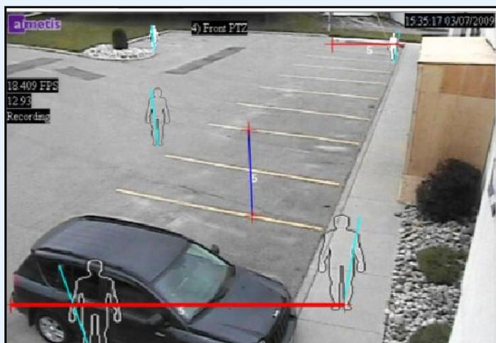
Abbildung 9. Betriebsmodus „Analyse im Außenbereich“
